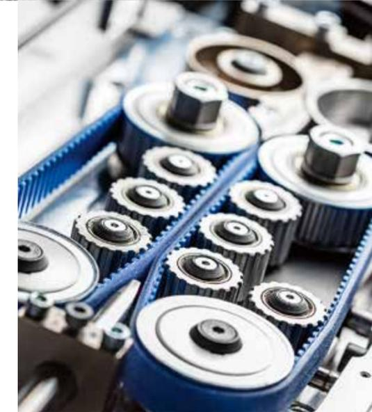
Der effiziente Bandantrieb zieht die Kabel mit einer Geschwindigkeit bis zu 9 m/s zuverlässig ein.
