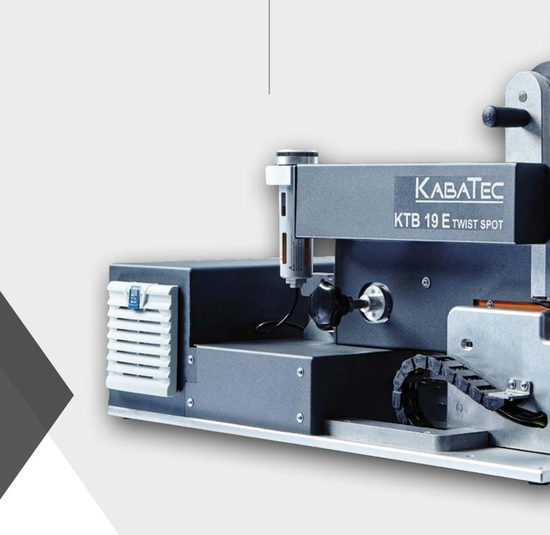
Pis zu 5 verschiedene Programme können gespeichert werden - unabhängig vom Vorprozess. Verarbeitung von bis zu 10 mm Außendurchmesser der verdrillten Leitungen.
