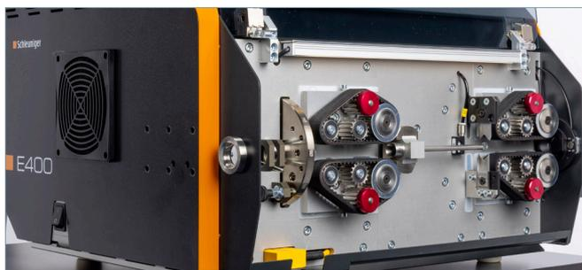
不同的进料带和带辊涂层可确保电缆的最佳输送效果。进给装置上配备可编程的触点压力。E400 的皮带传动系统配有集成短工件套件。
