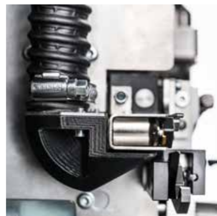
ストリップ後の剥きカスを除去するためのバキュームユニット (オプション)
