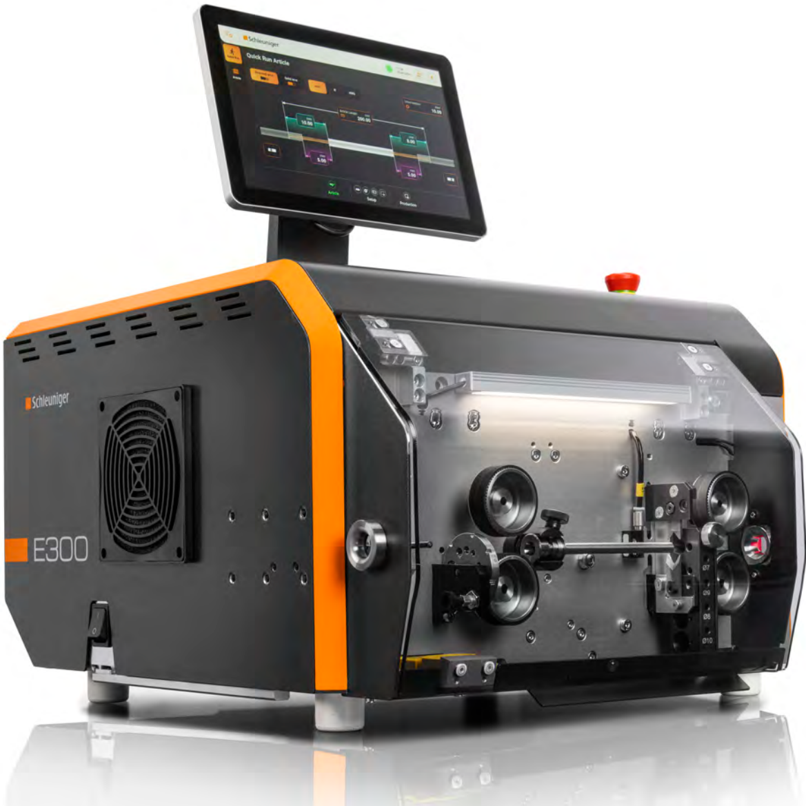
01 | 02 Verschiedene Zuführbänder und Beschichtungen der Rollen gewährleisten einen optimalen Transport der Kabel. Der Anpressdruck auf die Zuführeinheit ist programmierbar. Die E300 ist mit einer für Bandrollenantriebe geeigneten 2-in-1-Schnellwechsel-Zuführeinheit ausgestattet und beinhaltet einen Kurzteilesatz zur Verarbeitung von kurzen Kabeln. 03 Die E300 Einschneide- und Abisoliermaschine kann mit vielen Peripheriegeräten kombiniert werden, um eine automatische Bearbeitungsstrasse zu bilden. Bestehende Schleuniger Peripheriegeräte sind kompatibel. 04 Minimaler Schulungsaufwand und extrem kurze Inbetriebnahme dank S.Drive Software.
